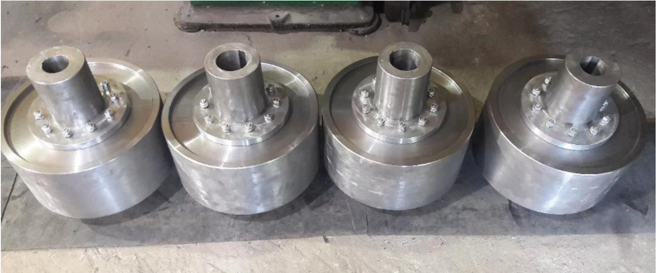
**Назначение:** Муфты общемашиностроительного применения для соединения соосных валов при передаче крутящего момента от 6,3 до 16000 Нхм и уменьшения динамических нагрузок при угловых, радиальных и осевых смещениях валов. Параметры и размеры муфт соответствуют ГОСТ 21424 упругие втулочно-пальцевые.
