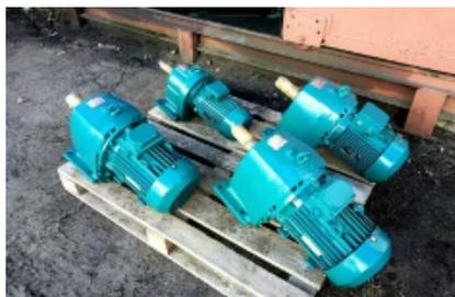
**Назначение:** Мотор-редукторы цилиндрические специальные: трехступенчатый 5Ц3-320 являются электромеханическими приводами реакторов биоокисления сульфидных концентратов, которые используются в золотодобывающей промышленности. Мотор-редуктор представляет жестко связанные между собой электродвигатель и редуктор, составленный из (трех) ступенчатой цилиндрической зубчатой передачи с эвольвентным зацеплением, расположенной в вертикальной плоскости.
